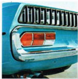
Particolari della parte posteriore: la protezione metallica per il + vetro di coda -; i fanali posteriori con incorporata la luce retromarcia
