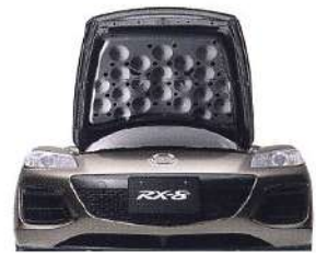
ショックコーンアルミ製ボンネット ※撮影のための遮音材をはずしてあります。
