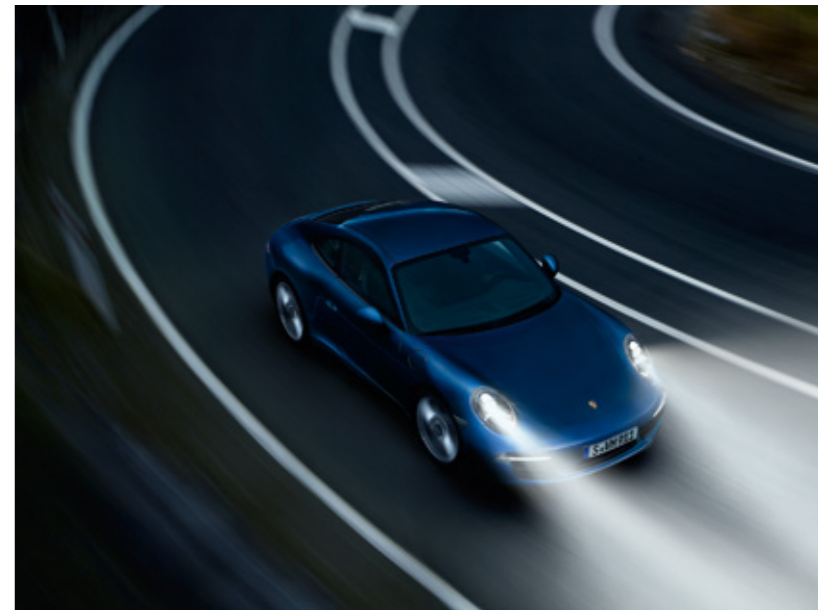
Kurvenlicht des Porsche Dynamic Light System (PDLS)
