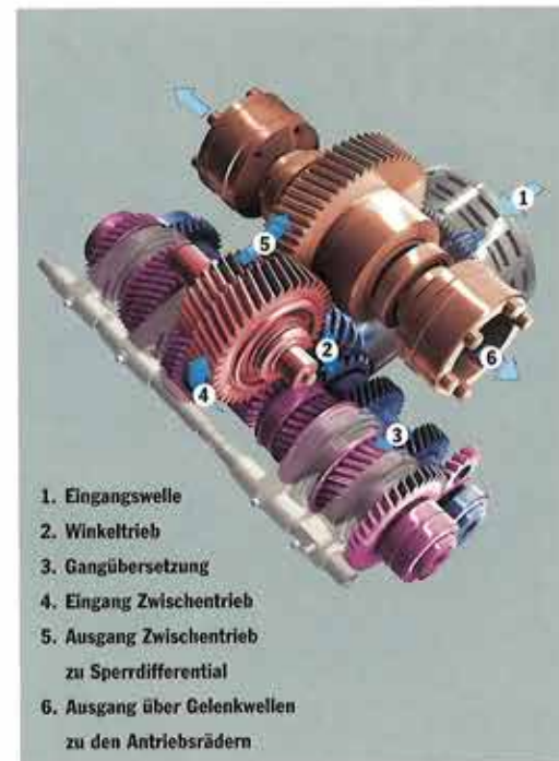
Kraftfluß im Getriebe
